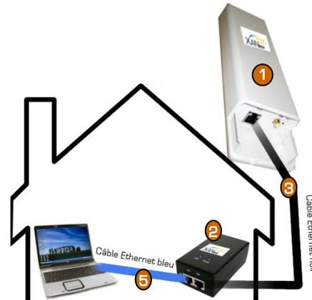
**Connectez** l'autre extrémité du câble réseau noir 3 dans la prise POE du bloc d'alimentation 2
